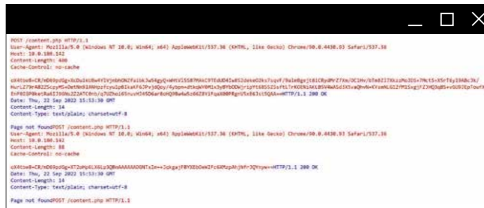
Рис. 6. Типичный HTTP-трафик BRC4. Все данные передаются в теле POST-запроса, остальные параметры настраиваются
